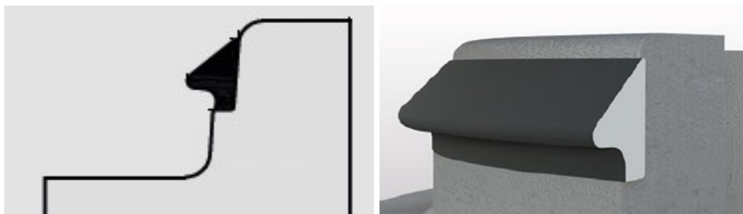
Obr. č.3: dílek trouby s těsněním
