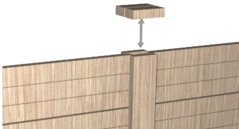
Obr. 5 – Schéma umístění plotové hlavice na sloupek
